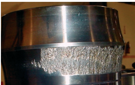
8: Schadensverlauf am Planetenlager, Innenring und Laufkörper
