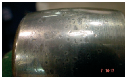
8: Schadensverlauf am Planetenlager, Innenring und Laufkörper
