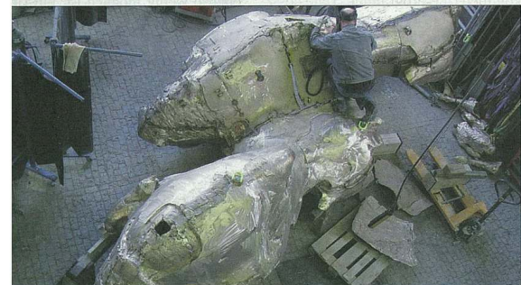
die Zentrale von Red Bull schuf der Osttiroler Künstler Jos Pirker eine Plastik, die den großen Bullen darstellt. Gegossen wird diese von der Bildgießerei Noack in Ber- lin. Die 18 t schwere Skulptur muss aufwändig geputzt, ziseliert und patiniert werden.
